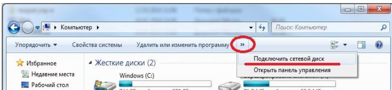
Рисунок 4. Подключение сетевого диска в папке «Мой компьютер»
